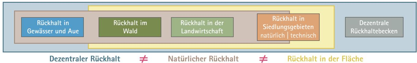
Abb. 2: Begriffsbestimmungen und Komponenten im dezentralen Rückhalt
