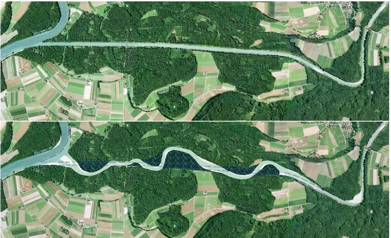
Abb. 3 (oben): Die kanalisierte Thur um 2000 (Orthofoto), Abb. 3 (unten): Die befreite Thur Vision 2020 (Orthofoto) als Projektidee und -grundlage.
