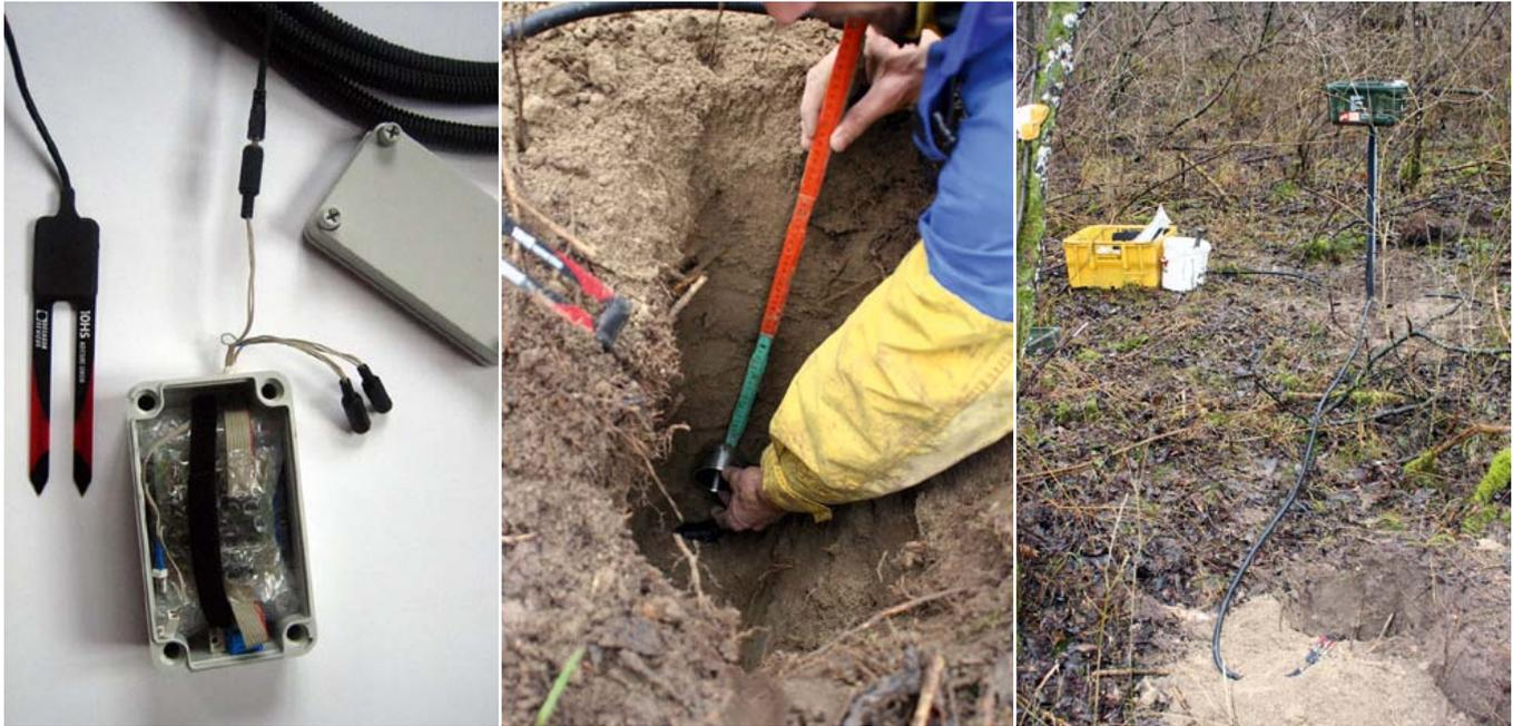
Abb. 3: Bodenfeuchtesonde 10 HS und Datenlogger (links). Ungestörte Bodenprobenahme mit Stechzylinder (Mitte). Installation einer Bodenfeuchtestation mit Verlegung der Sensoren im Kabelschutzrohr (rechts). Fotos: P. Fischer.
