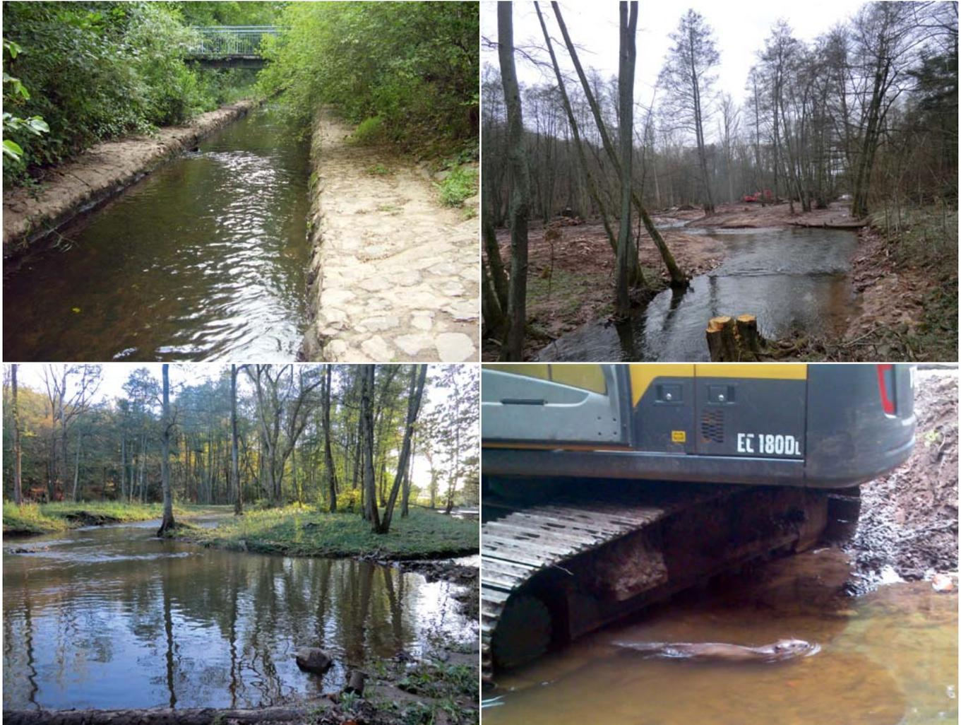
Abb. 8 (l. o.): Köllerbach im Unterlauf in Völklingen 2008. Der Gewässerlauf wurde komplett in Wasserbausteinen in Beton gefasst und begradigt. Seit dem Ausbau in den 1960er Jahren konnte sich der Gewässerlauf nicht eigendynamisch entwickeln und verblieb in seinem vorgegebenen Korsett (Foto: M. Boes).
