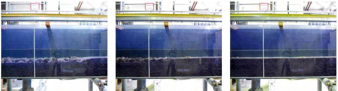
Abbildung 2: Laborversuch Schritt 1 – Abflusszustand entspricht ablaufender Hochwasserwelle – Rauteppich sedimentiert zu (Fließrichtung und Ablauf von links nach rechts). (Quelle: hydrophil-iC)
