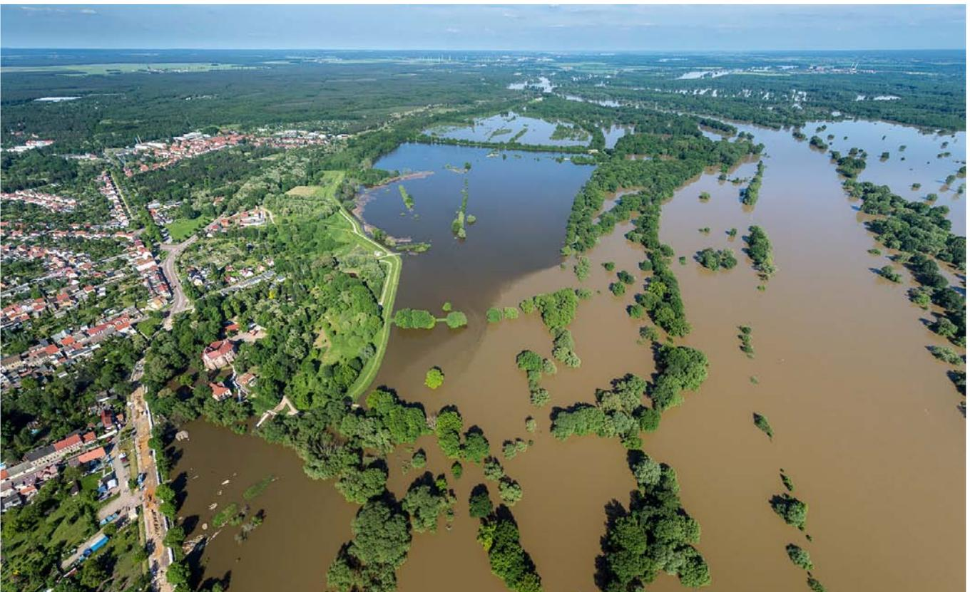
Abb. 3: Deichrückverlegung als Renaturierungsmaßnahme am Beispiel des Roßlauer Oberluchs bei Dessau-Roßlau (Biosphärenreservat Mittelbe), Überflutung der Aue während des Elbehochwassers im Juni 2013 (Foto: André Künzelmann, UFZ).
