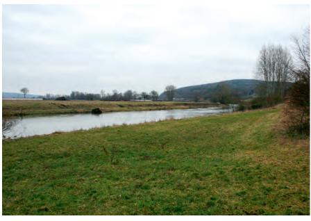
Abb. 1: Zustand vor der Mainverlegung: begradigter, versteinter und strukturarmer Flussverlauf mit Trapezprofil
