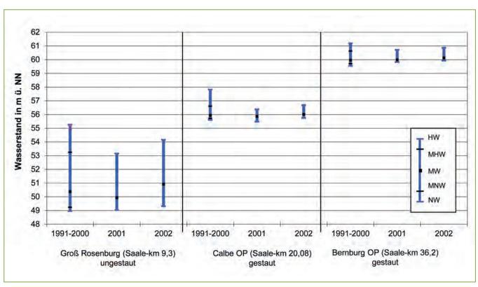
Abb. 3: Vergleich der Wasserstandshauptzahlen (HW, MW, NW) bei Groß Rosenburg, Calbe OP und Bernburg OP; bei den Jahresreihen 1991 – 2000 ist jeweils noch der MHW und NHW eingezeichnet (NW: Niedrigwasser, MNW: Mittlerer Niedrigwasserstand, MW: Mittelwasser, MHW: Mittlerer Hochwasserstand, HW: Hochwasser) (Datenquelle Wasser- und Schifffahrtsamt Magdeburg)
