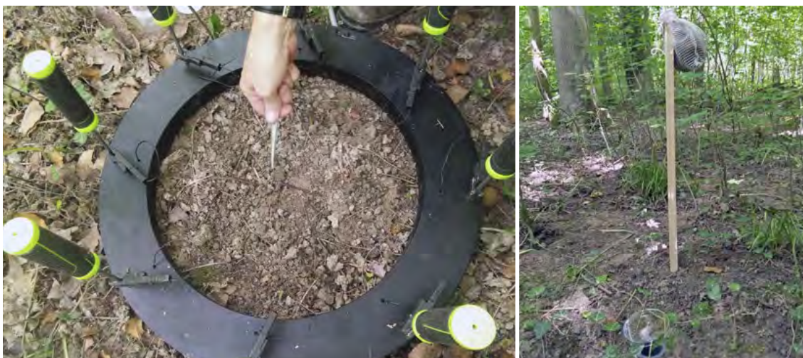
Abb. 2: Für die Erhebung der Bodenfauna wurden Würmer mit der Oktettmethode extrahiert und Barberfallen für Arthropoden aufgestellt. Der Beutel enthält Haare, um Wildschweine zu vergrämen. (Fotos: Mareike Roeder)
